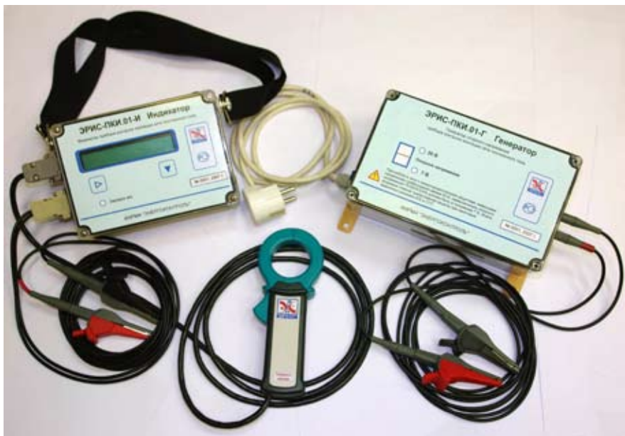
Рис. 2. Прибор для поиска мест повреждения изоляции в сети оперативного постоянного тока «ЭРИС-ПКИ.01»
